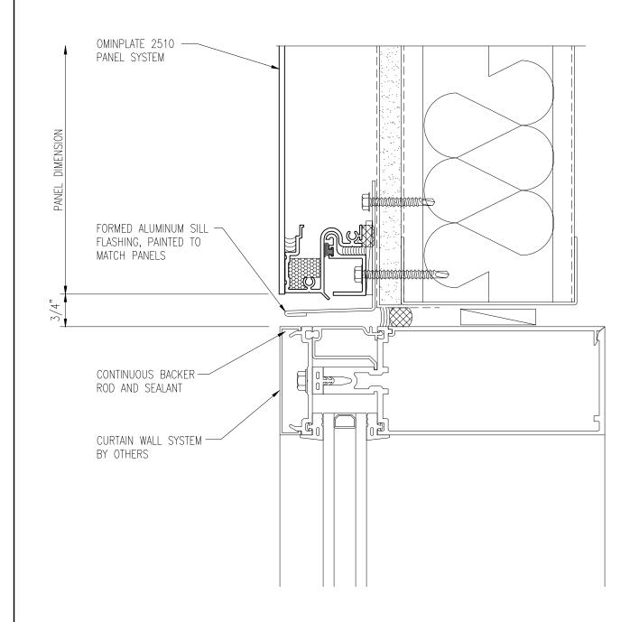
PRIMARY WALL CONSTRUCTION AND INSULATION NOT BY METALWERKS. 16 GAGE METAL STUDS MINIMUM REQUIRED
