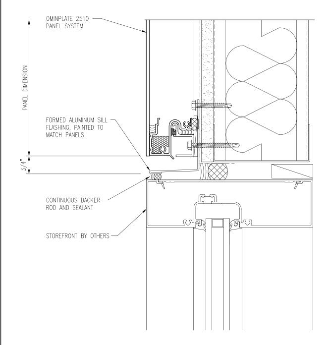
PRIMARY WALL CONSTRUCTION AND INSULATION NOT BY METALWERKS. 16 GAGE METAL STUDS MINIMUM REQUIRED
