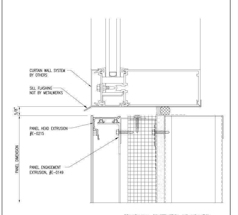
PRIMARY WALL CONSTRUCTION AND INSULATION NOT BY METALWERKS. 16 GAGE METAL STUDS MINIMUM REQUIRED
