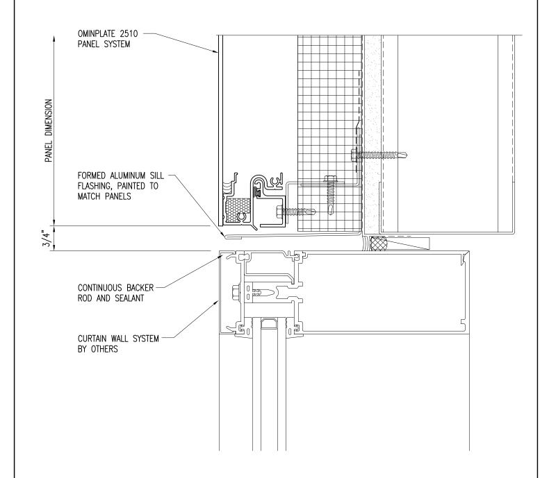
PRIMARY WALL CONSTRUCTION AND INSULATION NOT BY METALWERKS. 16 GAGE METAL STUDS MINIMUM REQUIRED
